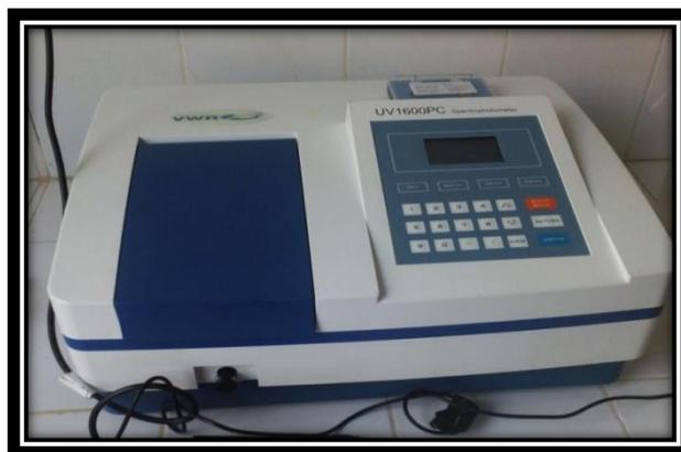
Figure 25: Le spectrophotomètre UV 1600 PC (LGG)
