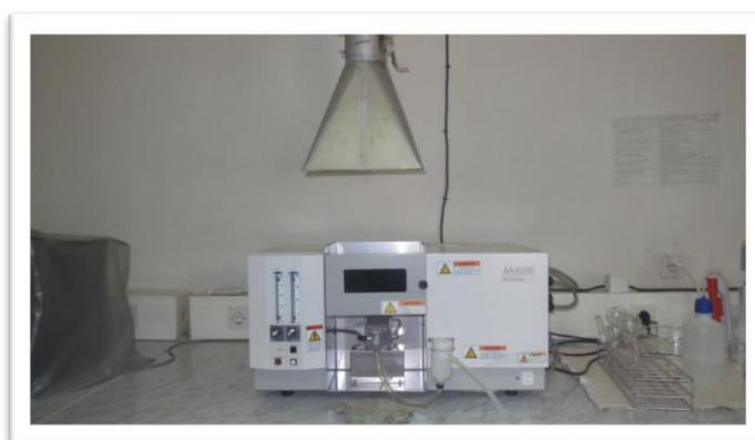
**Figure 27 : Le spectromètre d'absorption atomique (AA-6200 SHIMADZU).**
