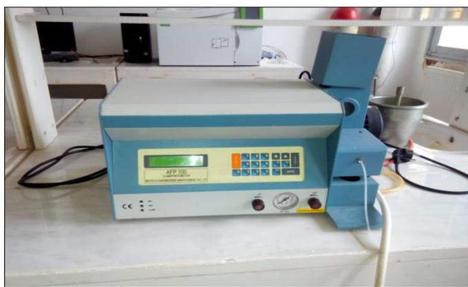
Figure 26 :Flamphotomètre (AFP 100).
