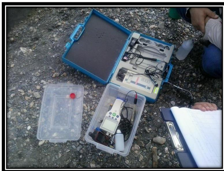
Fig.23: Valise multi-paramètre utilisée pour les mesures des paramètres In Situ.
