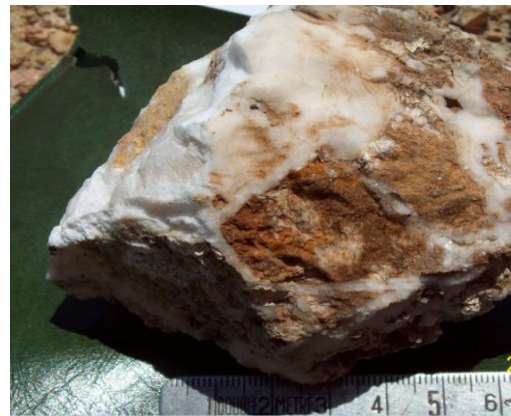
Fig.IV.10 : Echantillon de limonite on boxwork couvert par une enveloppe de calcite
