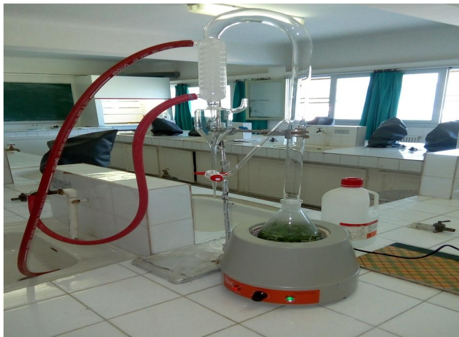
Figure III.01: Montage d'hydrodistillation employé pour l'extraction de l'huile essentielle.
