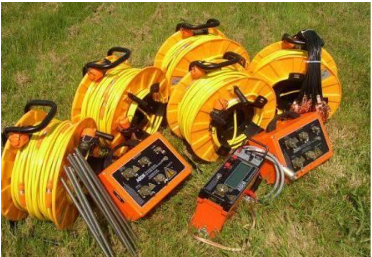
Figure 16- matériel utilisé dans la réalisation des sondages électriques verticaux
