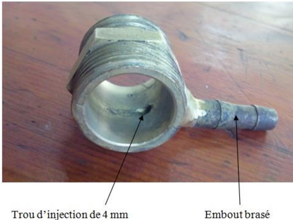
Figure II.3 : Mamelon grand modèle avec trou d'injection tangentiel et embout brasé pour l'alimentation en air comprimé.
