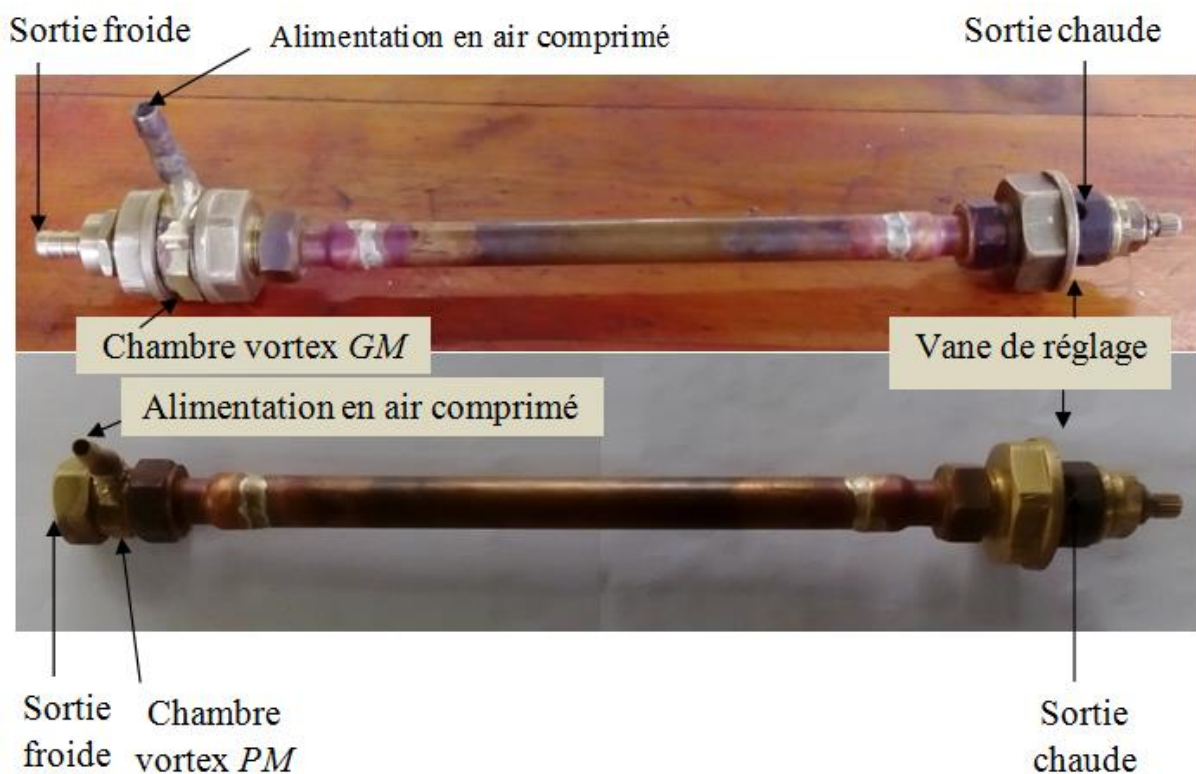
Figure II.5 : Tube vortex assemblé. Grand modèle(GM) et petit modèle(PM).
