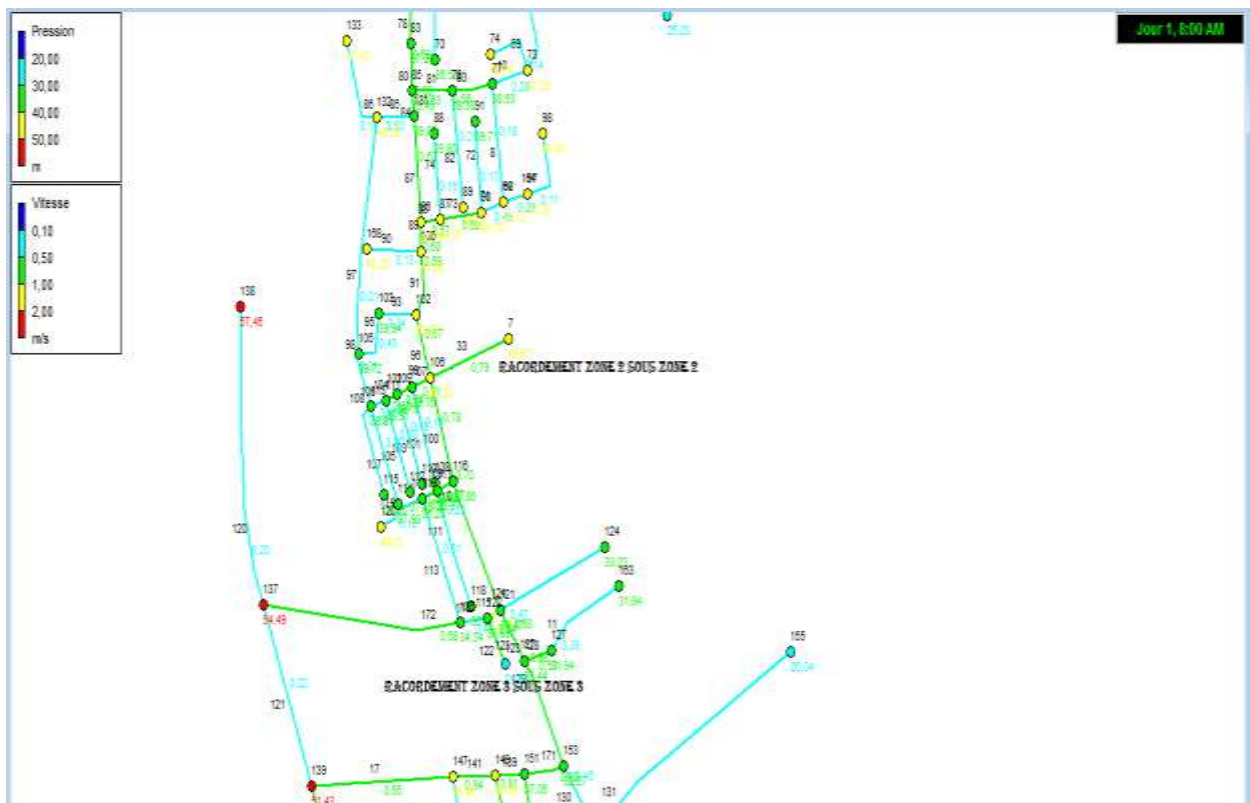
Figure (III.10) suit : Résultats de la simulation (pression et vitesse)
