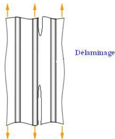
Figure II.4: Délaminage d'un composite [5].
