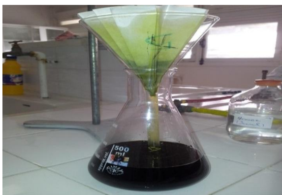
Figure 25 : La filtration à l'aide du papier Whatman N°3
