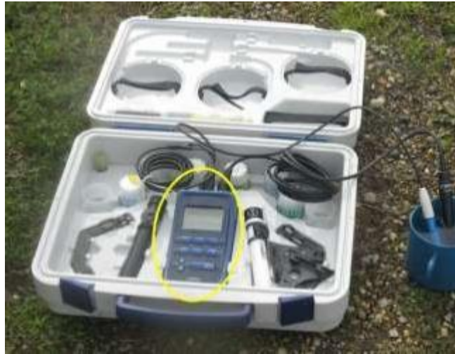
Figure15: Multi-paramètres (WTW 305i) et pH-mètre (Mettler Toledo)
