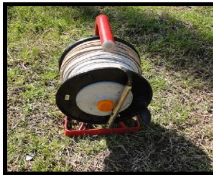
Figure15 : Photo de la sonde piézométrique.
