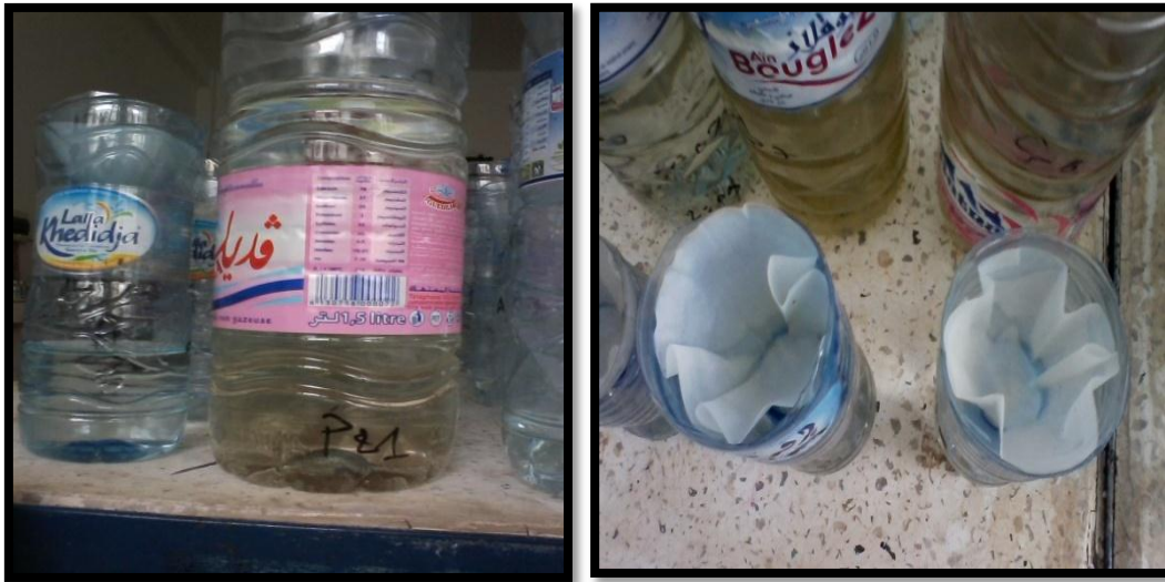
Figure18 : Photos montrant la filtration gravitaire
