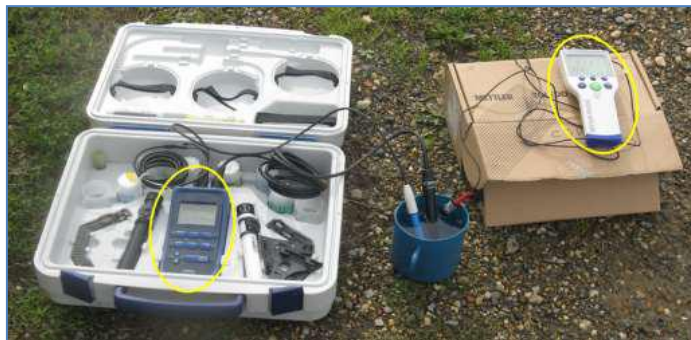
Figure.31 Multi-paramètres (WTW 305i) et pH-mètre (Mettler Toledo).
