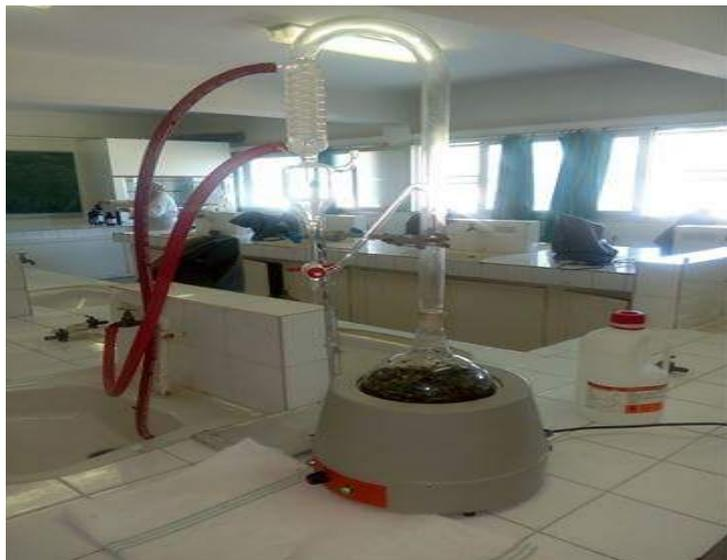
**Figure 14 :** Montage du dispositif d'hydrodistillation de type clevenger
