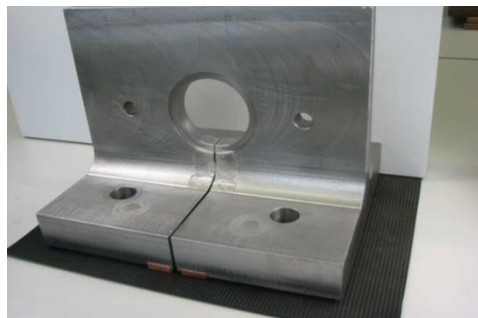
Figure I-13: Une bobine mono spire de la machine de soudage [13]
