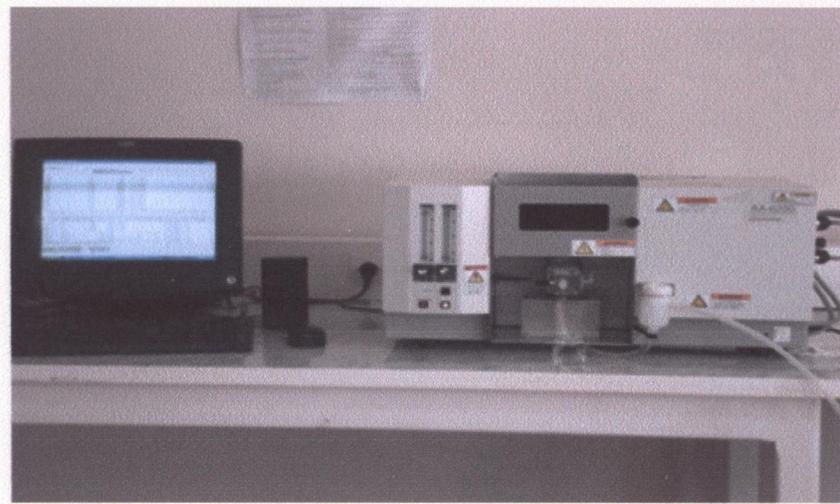
**Figure 10 :** La spectrophotométrie d'absorption atomique (SAA).
