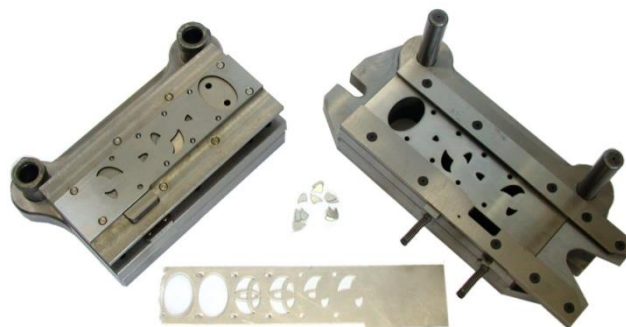
Fig. I. 9 : Matrice progressive (ouverte) utilisée pour réaliser le logo de Toyota [w3].
