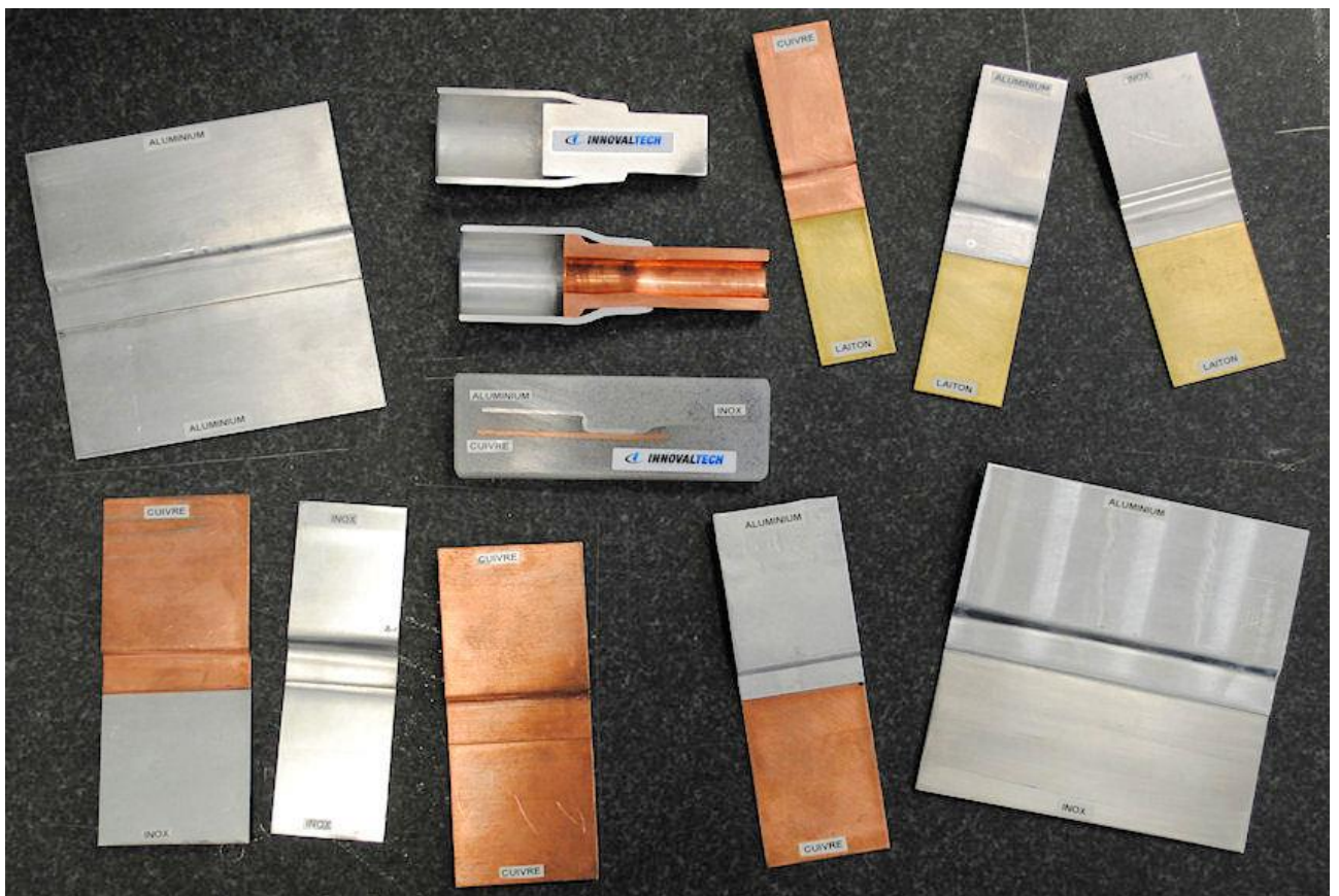
Figure I-24 : Soudage de différents matériaux
