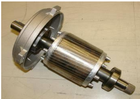
a : Emplacement des barres du rotor.
