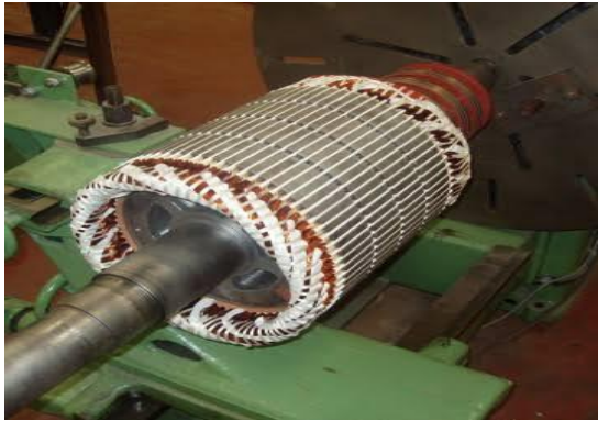
a : Disposition des enroulements dans un rotor bobiné
