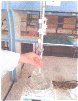
Figure 10 : méthode de Kjeldahl : dosage de l'ammoniac et changement du milieu vert vers gris sale
