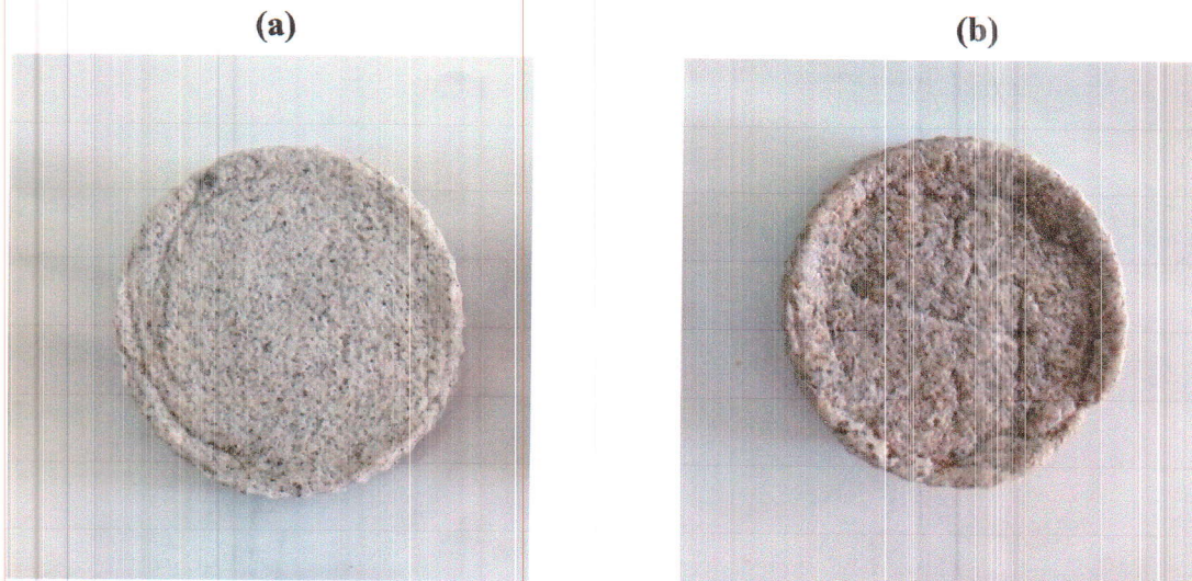
Fig [II.7]: Echantillons du matériau d'essai pour les quantités massiques (a): m(S) = 2m(PS) et (b) : m(S) = 1,5m(PS) . S=Sable 2 et 4 respectivement.
