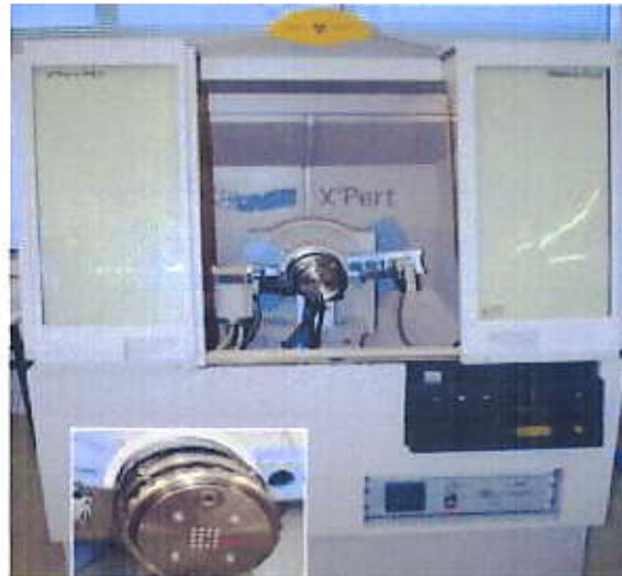
Figure 2.11 : Diffractomètre de type X'Pert Pro
