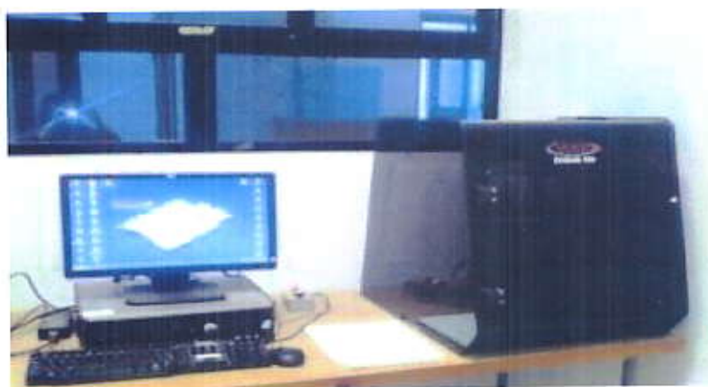
Figure 2.21 : profilomètre Dektat 150 (Veeco)
