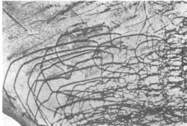
Figure I.5. Première observation de dislocations individuelles dans un cristal de silicium par la technique de topographie par rayons X [5].
