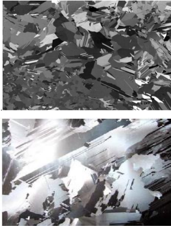
Figure 1.14. Structure de grains dans une plaquette de silicium multi-cristallin [2].
