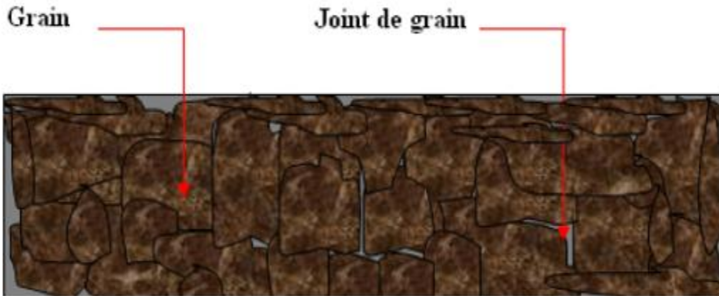
Figure I.17. Structure granulaire d'un film de silicium polycristallin [9].
