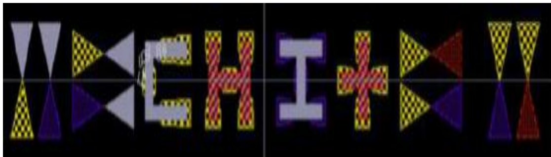
Figure II.12. Image de l'éditeur de plan Cadence des repères d'alignement utilisés pour la fabrication des rubans de graphène. Les marques en noir et jaune sont celles gravées dans le \text{SiO}_2 , les marques en rouge sont définies dans le graphène et les marques en gris et en bleu sont définies pour les contacts métalliques [49].
