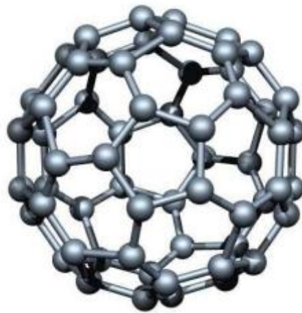
Figure I.6. Structure cristalline du fullerène C60 [10].
