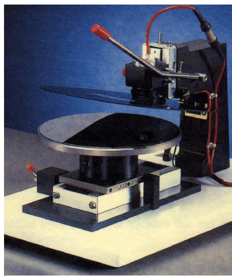
Figure I.15: Dispositif Jandel de mesure de la résistivité par la méthode des quatre pointes [14].
