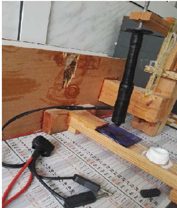
Figure II.8: Ancien dispositif des quatre pointes alignées (LEM).
