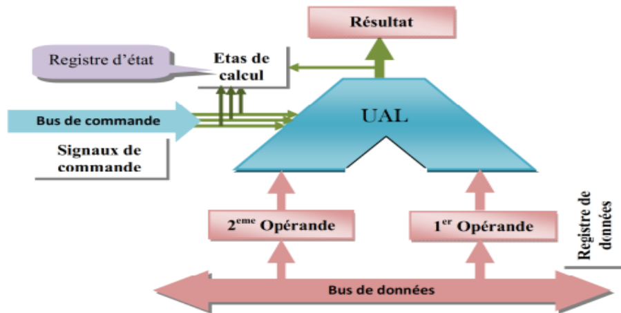
Figure I.27 : structure de l'unité arithmétique et logique [41].
