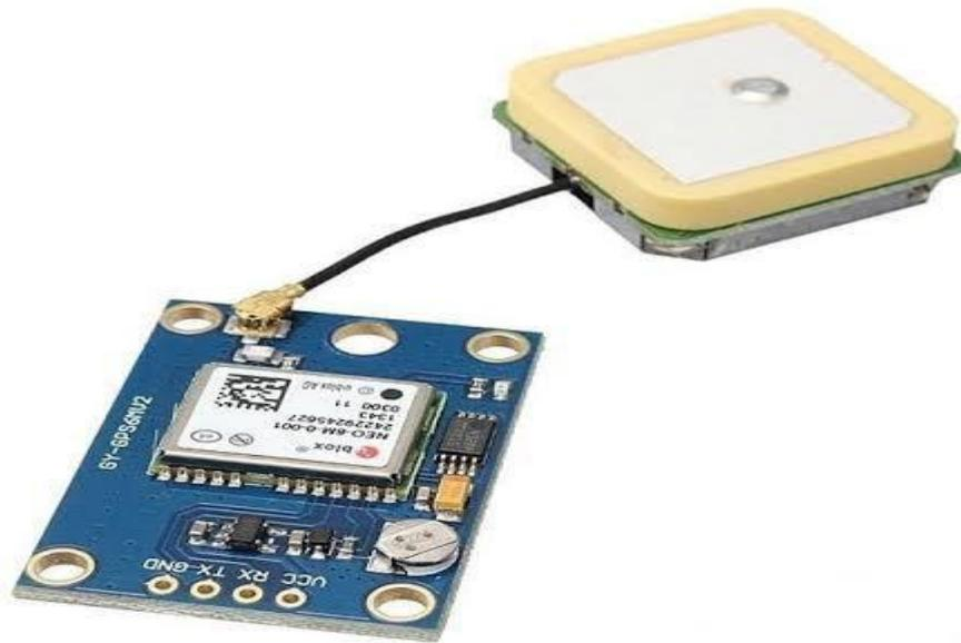
**Figure 3.5 :** *Le Module U-BLOX NEO-6M [9].*
