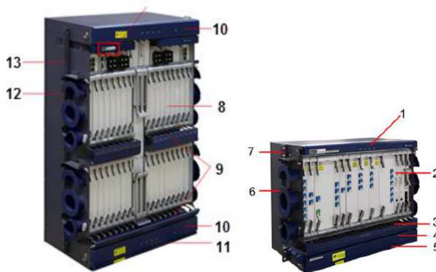
Figure 12. Structure d'équipement HUAWEI OSN 6800 et 8800.
