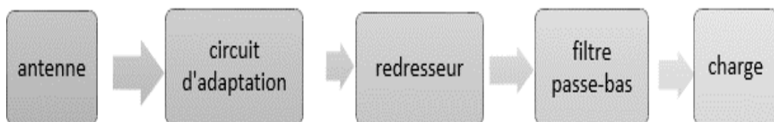
Figure II.1 : Structure générale d'une Rectenna
