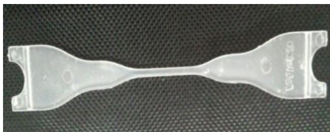
Figure II.18 : Eprouvette type en plastique pour la préparation du moule
