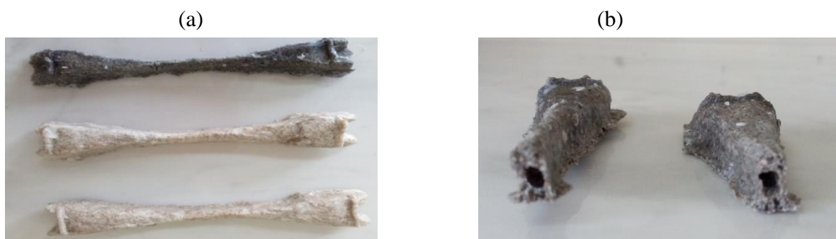
Figure II .21 : (a) Eprouvette obtenue après l'augmentation des épaisseurs et avant polissage. (b) : Présentation de pores au niveau de la partie droite en forme de tunnel dans l'échantillon S-PS-PF.
