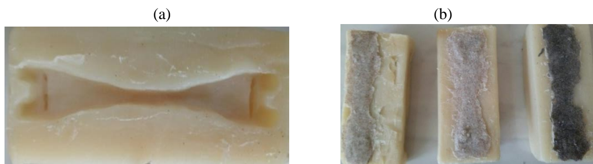
Figure II. 20 : (a) Empreinte de 'l'éprouvette type ' sculptée sur le savon. (b) moulage des échantillons.
