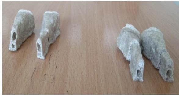
Figure II.22 : Pores en forme de tunnel au niveau de la partie droite des éprouvettes S-PS et S-PS-PM
