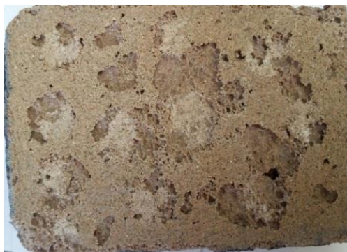
Figure II.11 : Zone des dix martèlements sur la surface de l'échantillon S-PS.
