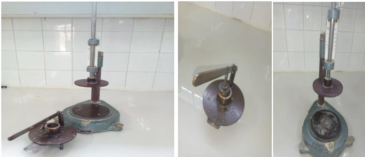
Figure II. 8 : L'appareil PFEFFERKORN de plasticité.
