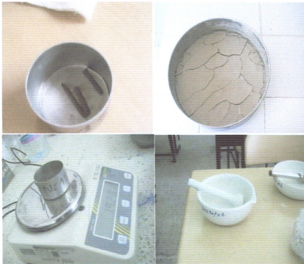
Fig. V.6 : Matériels utilisé dans la détermination des limites d'atterberg (Laboratoire de matériaux, Département STU, 2013)
