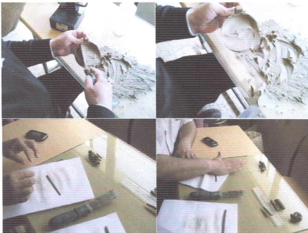
Fig. V.7 : Détermination de la limite de liquidité à la coupelle, et la limite de plasticité au rouleau (Laboratoire de matériaux, Département STU, 2013)
