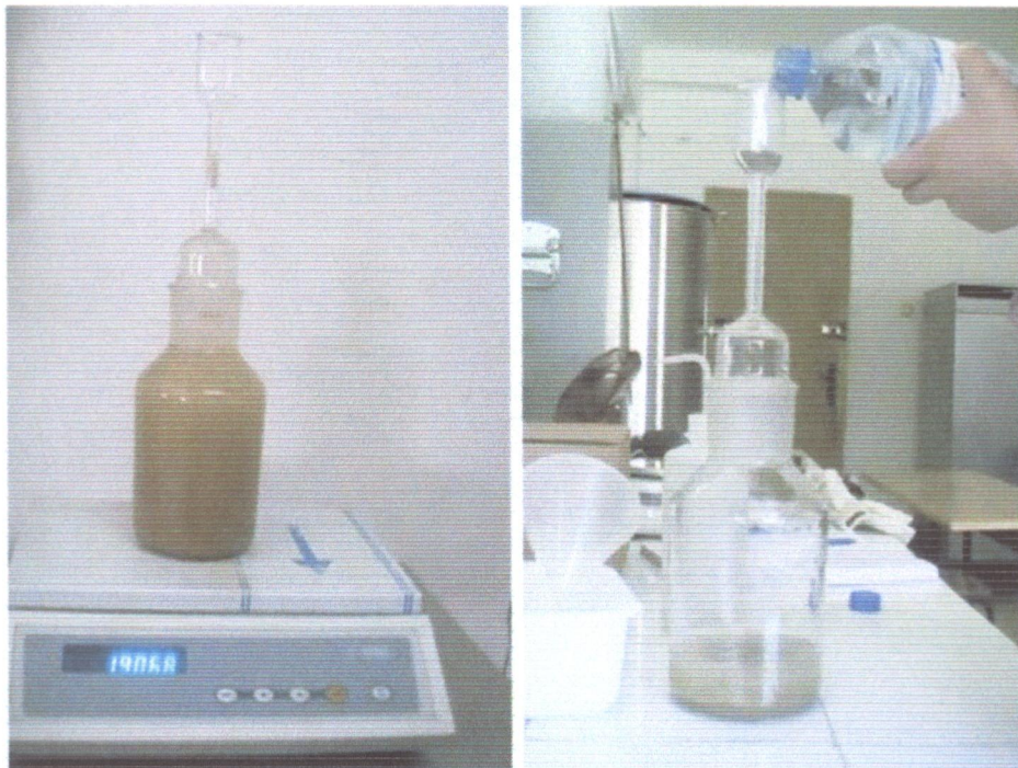
Fig. V.2 : Mesure de la masse volumique des grains solides par la méthode du pycnomètre (Laboratoire de matériaux, Département STU, 2013)
