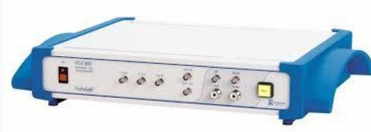
Figure II.5: Potentiostat-Galvanostat (votalab 40).
