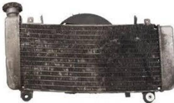
**Figure I.14** : corrosion de radiateur de chauffage.
