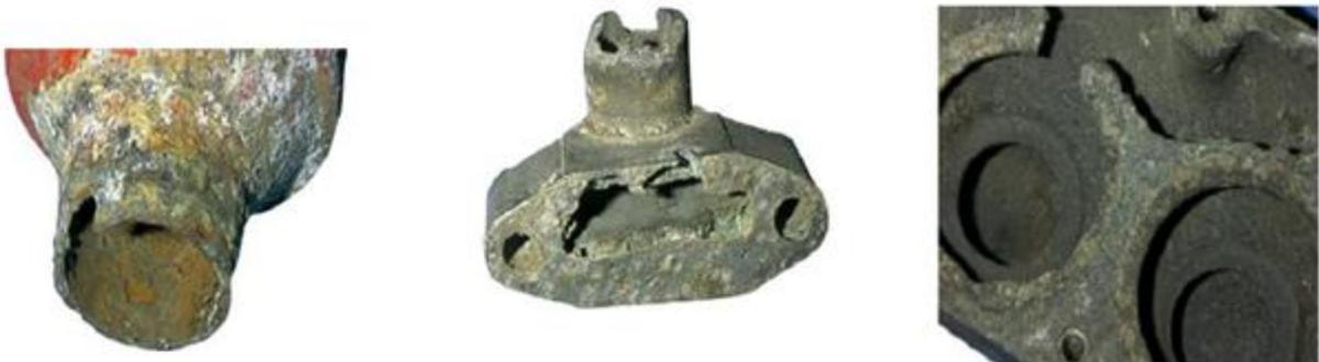
**Figure I.15** : corrosion générale de pièces en alliage d'aluminium d'un moteur.
