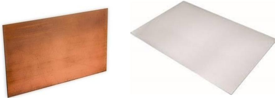
**Figure II.1** : électrodes de cuivre et d'aluminium.
