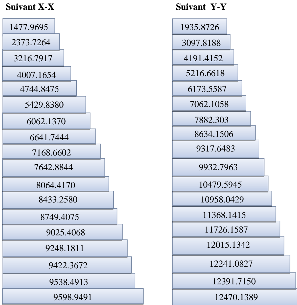
Fig V.8 : Distribution de l'effort tranchant selon la hauteur.
