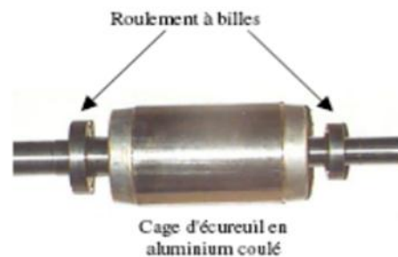
Figure I.6 : photo du rotor d'une machine asynchrone
