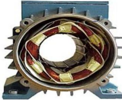
Figure I.5 : Stator d'une machine asynchrone triphasée.
