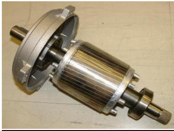
Figure I.7: Machine asynchrone à moteur à cage
