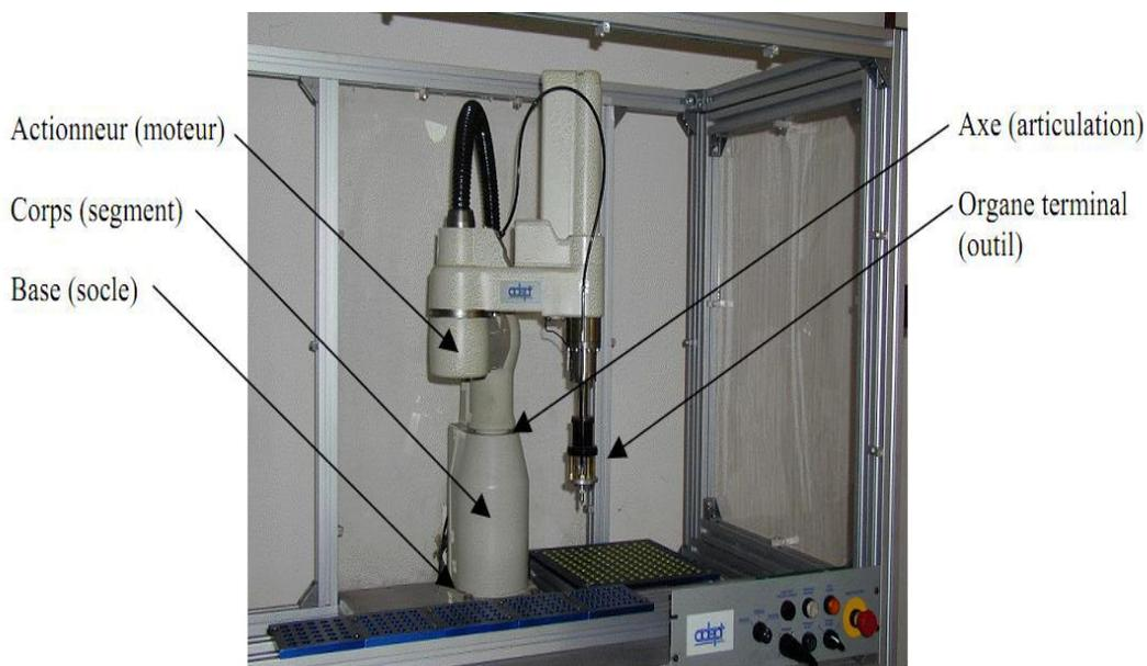
Figure 1.1 : Constitution d'un robot manipulateur
