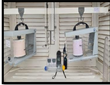
Figure IV. 14: mesure de la température de l'air et de l'humidité de l'air (station météorologique) Source (Auteurs 2019)
