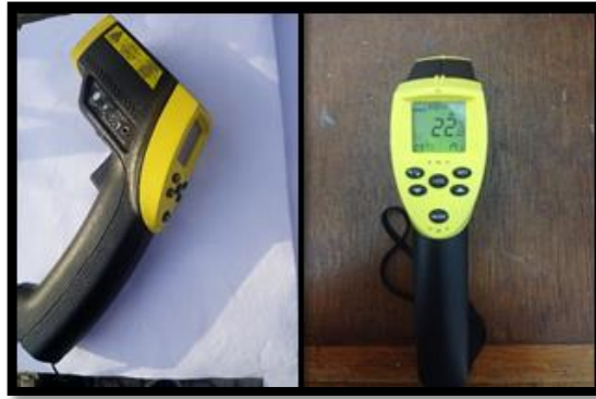
Figure IV. 12: thermomètre infrarouge (thermo laser) utilisée. (Source : auteurs 2019)
