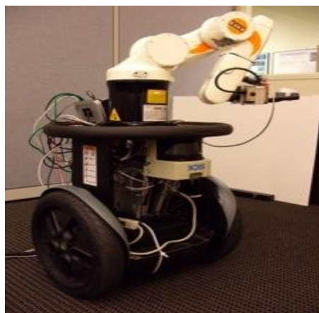
Figure.1.6. Plateforme Segway RMP200 avec manipulateur KUKA KR-5
