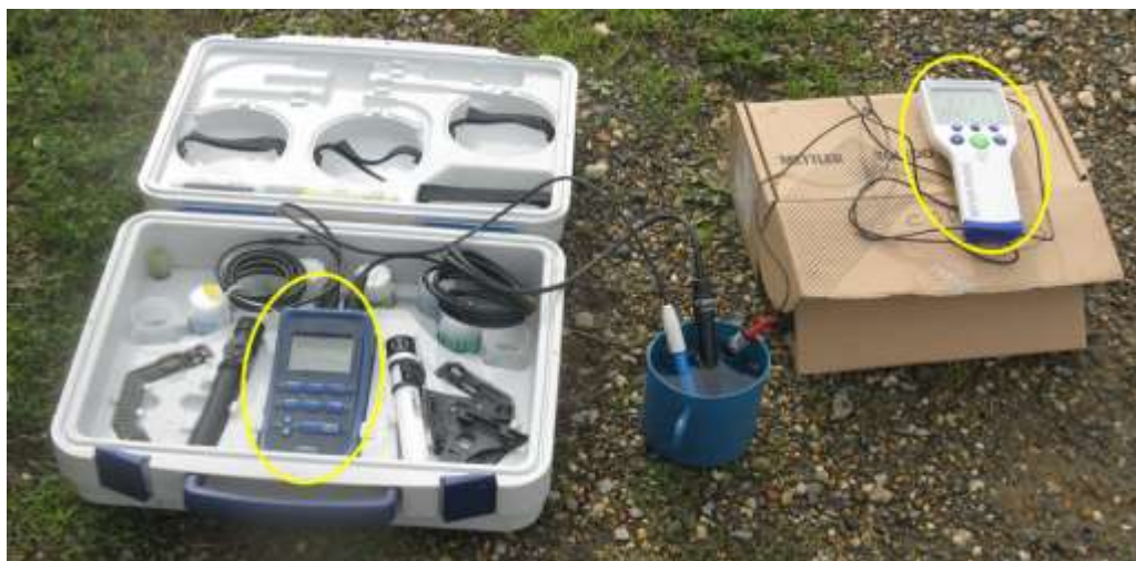
Figure 20 : Multi-paramètres (WTW 305i) et pH-mètre (Mettler Toledo).
