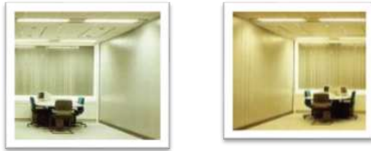
Photo 3: de gauche à droite , source froide;source chaude (Perception d'un même local éclairé par des sources de couleurs différentes).
