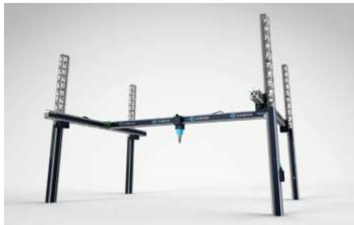
Photo III .11: Imprimante additive de construction à portique
