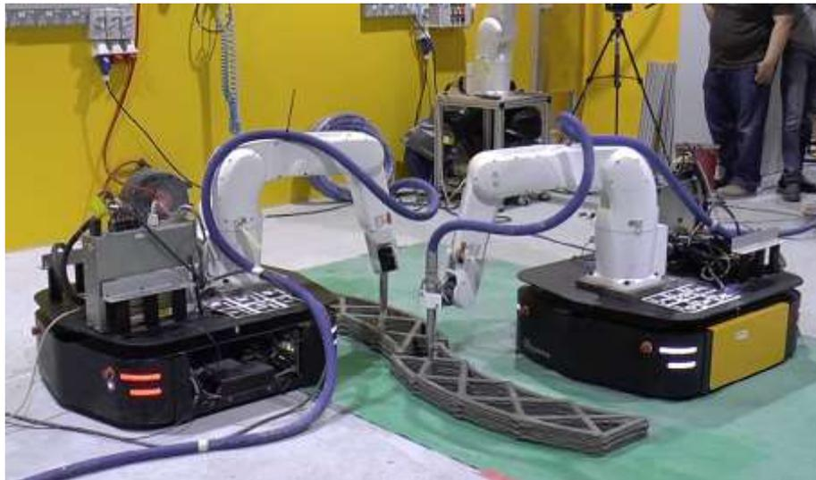
Photo III.13 : Approche en essaim dans l'impression additive à grande échelle
