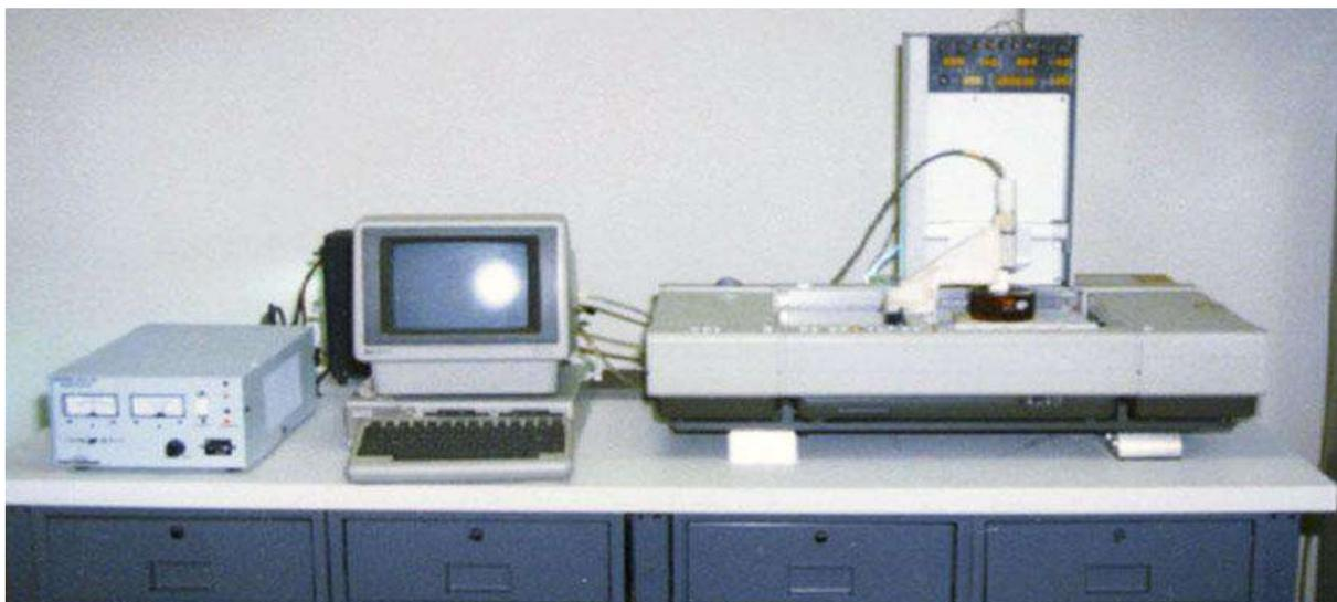
Photo II.3 : la première imprimante additive inventée par Chuck Hull source : (Krassenstein, 2015)
