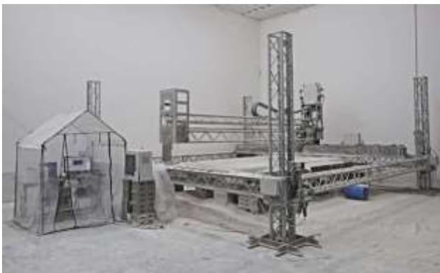
Photo III.8 : La deuxième génération de machine D-Shape.
