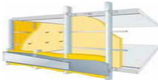
Figure02 : pose pose isolant Isoconfort 32. pose clés Optima2.
