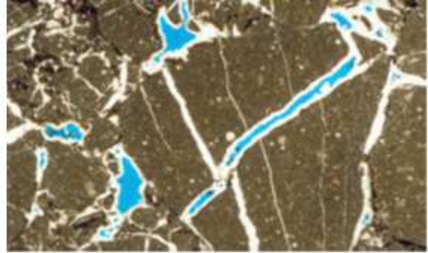
Photo 4- Porosité de fracture dans un calcaire de plateforme. La porosité, représentée par plusieurs générations de fractures, est partiellement réduite suite à la précipitation d'un ciment calcitique.
