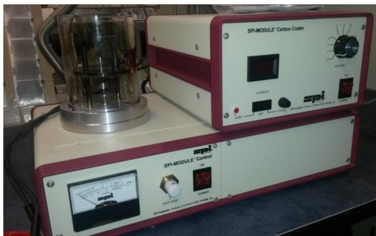
**Figure 37:** Appareil de métallisation de type "SPI-Module Carbon Coaster"
