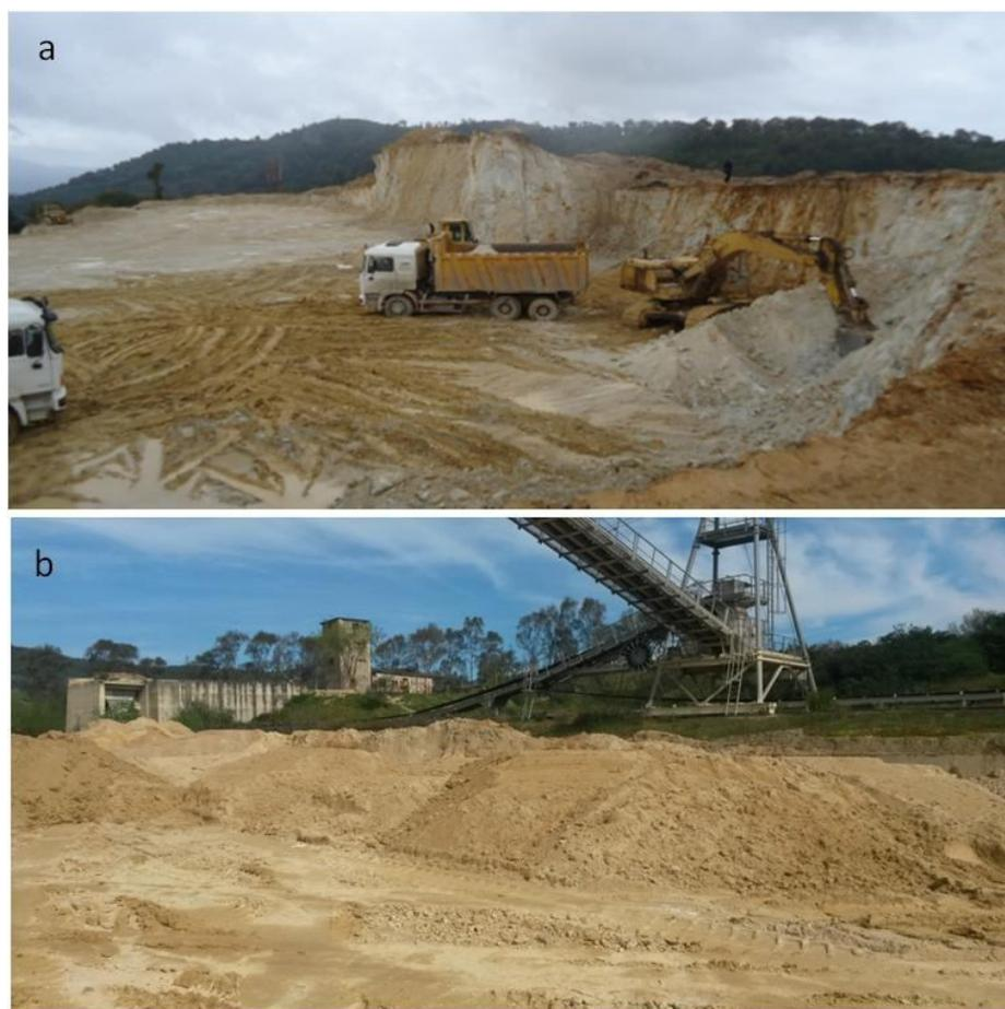
**Figure 29:** Images illustrant l'exploitation et le traitement du kaolin de Tamazert. **a)** Extraction du kaolin au niveau du corps central. **b)** Stockage du kaolin au niveau de l'usine pour traitement et d'enrichissement.
