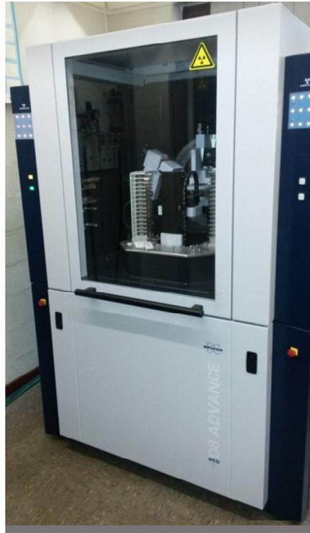
**Figure 33:** Diffractomètre de type Bruker D8 Advance (AGEs, ULg)
