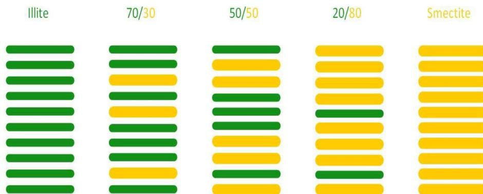
**Figure 12:** Variation des proportions de l'illite et de la smectite dans un interstratifié illite/smectite (Caner, 2011)
