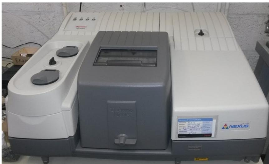
**Figure 35:** Spectromètre de type Nicolet Nexus 538 FT-IR (Laboratoire de minéralogie et cristallographie, ULg)
