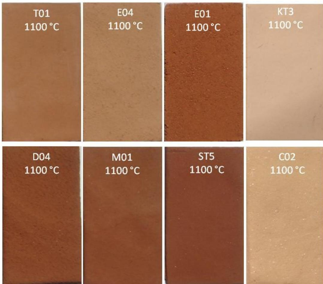
**Figure 70** : Coloration des carreaux céramiques après cuisson à température finale 1100°C.
