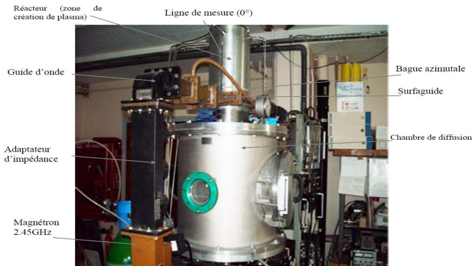
Figure 1.15. Photos du réacteur PECVD conçu au laboratoire (LPGP) [8].
