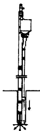
2. Le vibreur est foncé dans le sol jusqu'à la profondeur requise par vibration et injection d'air comprimé
