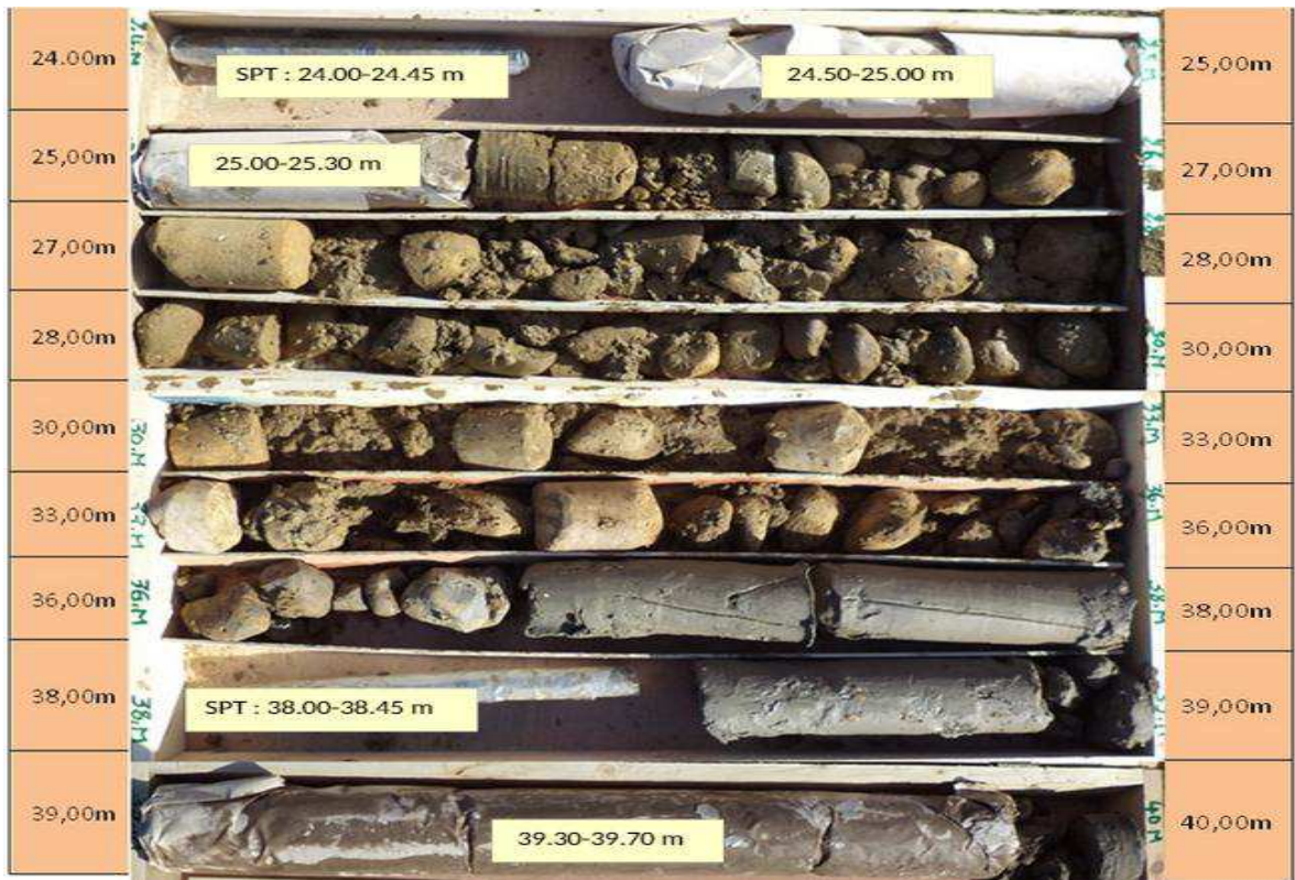
Figure 19: échantillons de sol aparté d'un sondage carotté.
