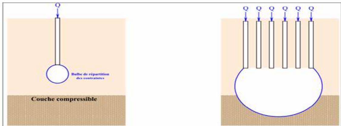
Figure 6: Représentation de la répartition des contraintes pour le cas d'un pieu isolé et le cas du groupe de pieu (TSTP, 2008).
