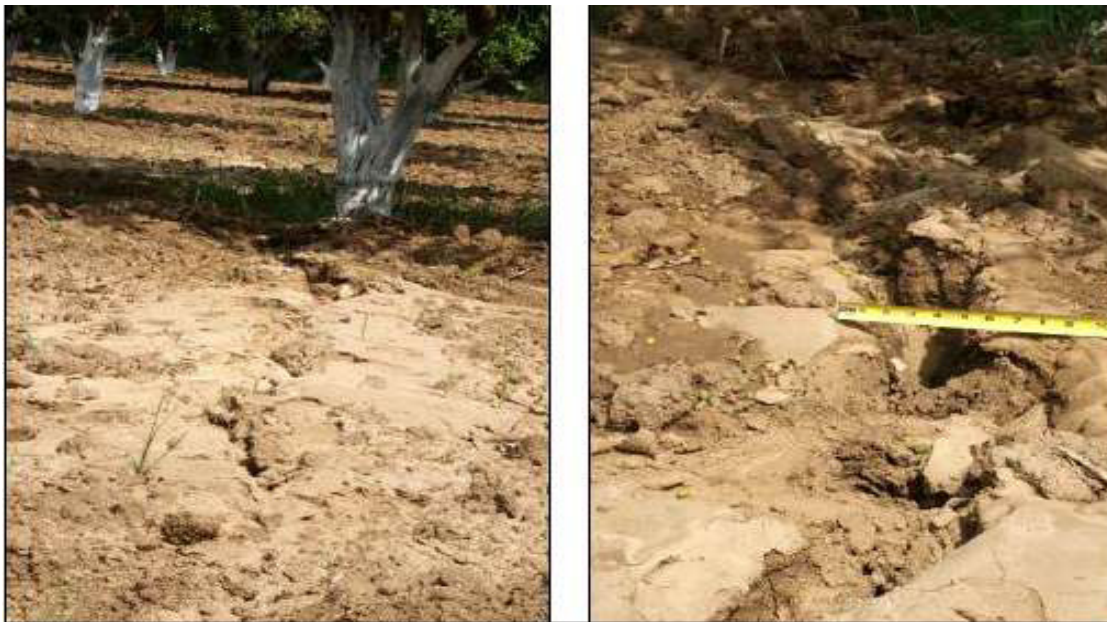
Figure I-21 Liquéfaction près de la ville de Zemmouri (ébullitions de sable).[9]
