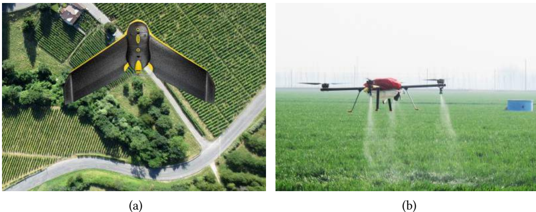
Figure 1.8: Utilisation de drone dans l'agriculture: (a) Drone à voilures fixes, (b) Drone à voilures tournantes
