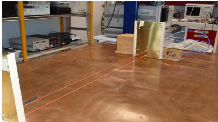
Figure IV.33 : Image montrant le système de mesure : Deux conducteurs droits au-dessus d'un plan entier.
