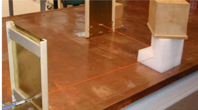
Figure IV.30 : Image montrant le système de mesure : un seul conducteur coudé à 90° au-dessus d'un plan entier.
