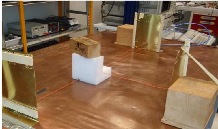
Figure IV.36 : Image montrant le système de mesure : Deux conducteurs au-dessus d'un plan entier ; un conducteur haut (1) coudé et un autre bas (2) droit.
