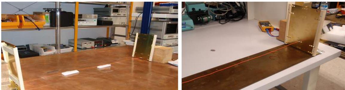
Figure IV.27 : Image montrant le système de mesure : un seul conducteur droit au-dessus d'un plan entier et d'un plan réduit à la taille de l'ombrage.
