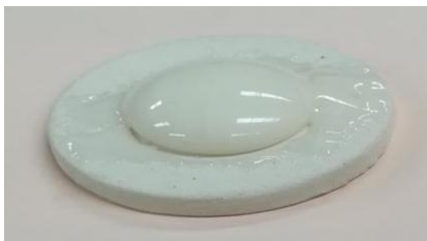
Figure II.13: Cônes de fusion du feldspath sodique.
