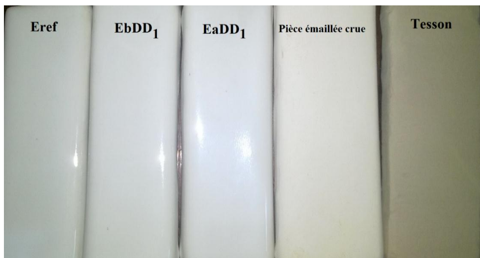
Figure IV.15 : Photographies de la pièce en céramique, pièce émaillée en crue et pièces émaillées cuites.
