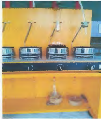
Figure 09 : méthode de Kjeldahl : étape de distillation
