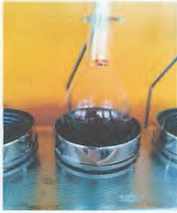
Figure 08 : méthode de Kjeldahl : étape de minéralisation
