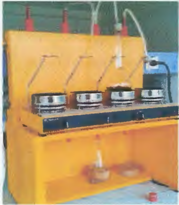
Figure 09 : méthode de Kjeldahl : étape de distillation
