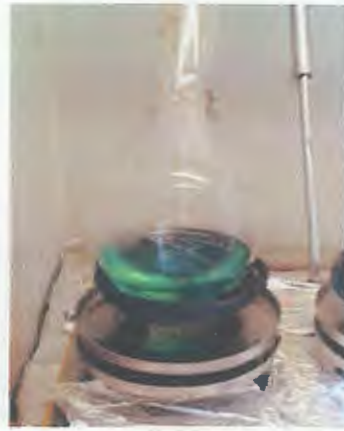
Figure 08 : méthode de Kjeldahl : étape de minéralisation
