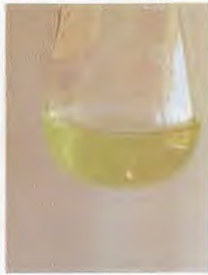
Figure 10 : méthode de Kjeldahl : dosage de l'ammoniac et changement du milieu vert vers gris sale
