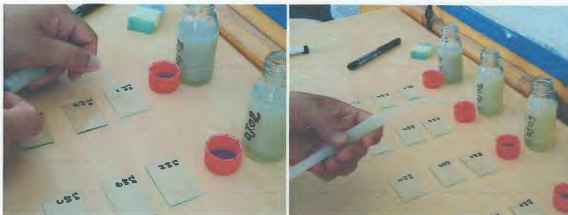
Photo. V.12 : Bouteilles de mise en suspension, et confection de lames orientées.
