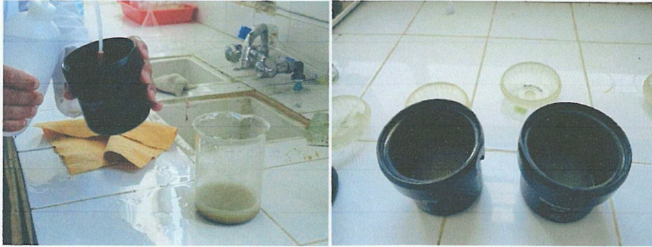
Photo. V.11 : Procédures de lavage des échantillons en vue de mise en suspension.
