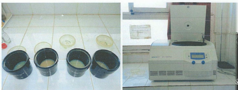
Photo. V.10 : Opération de lavage des échantillons par centrifugation
